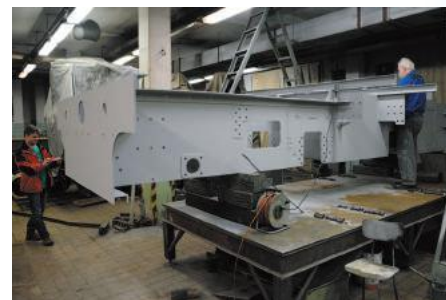
Rám lokomotívy po kompletnej renovácii
