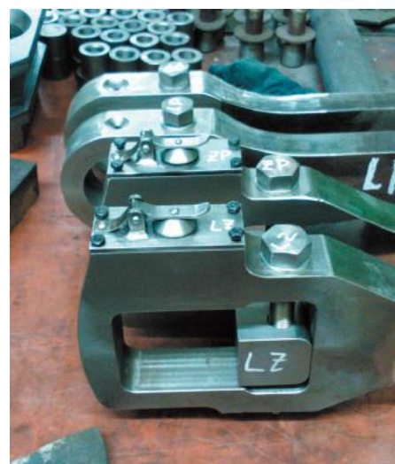
Tyčovie a ložiská sú už pripravené k namontovaniu
